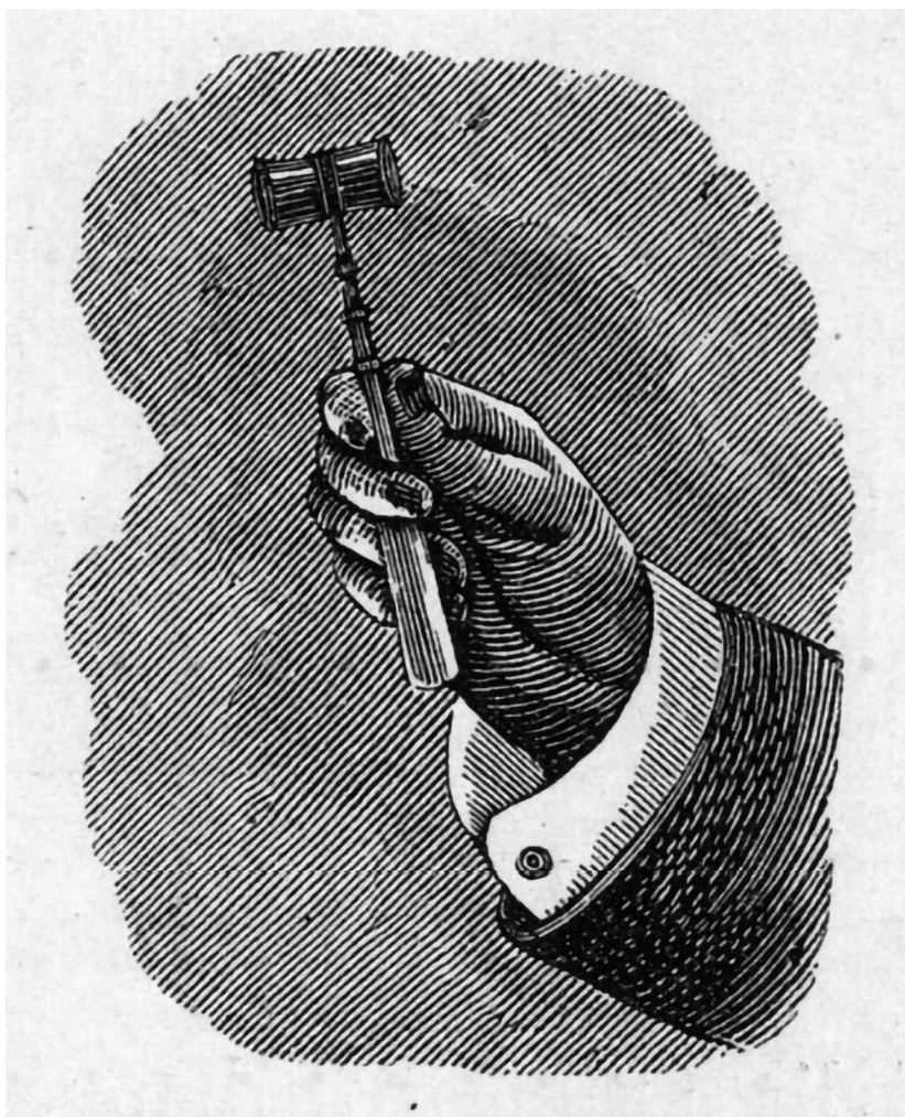
Bild 4.2. Illustration av hur blyhammaren ska hållas.
