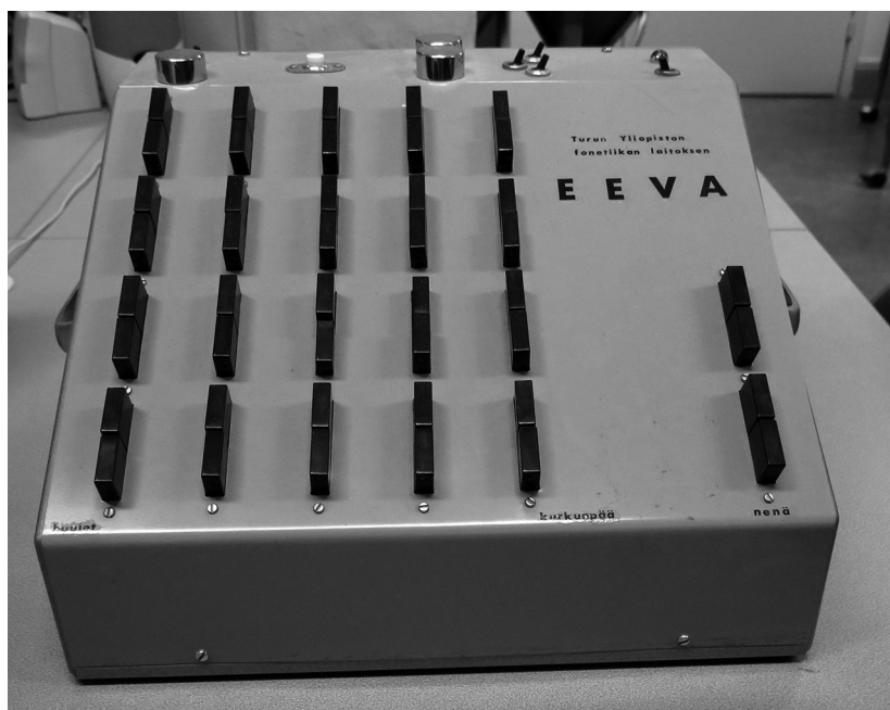
Bild 9.2. Syntetiseraren Eeva, tillverkad i slutet av 1960-talet på fonetiklaboratoriet i Åbo. Foto: Tiina Männistö-Funk.
