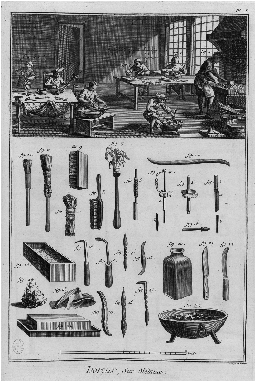
Bild 1.1. Arbete i en metallförgyllares verkstad, samt tillhörande utrustning och verktyg. Källa: Denis Diderot & Jean le Rond d'Alembert, L'Encyclopédie . [45]. Artisanats au 18ème siècle (Paris: 1751–1780), Doreur, Sur Métaux , PL. I. Bibliothèque nationale de France.
