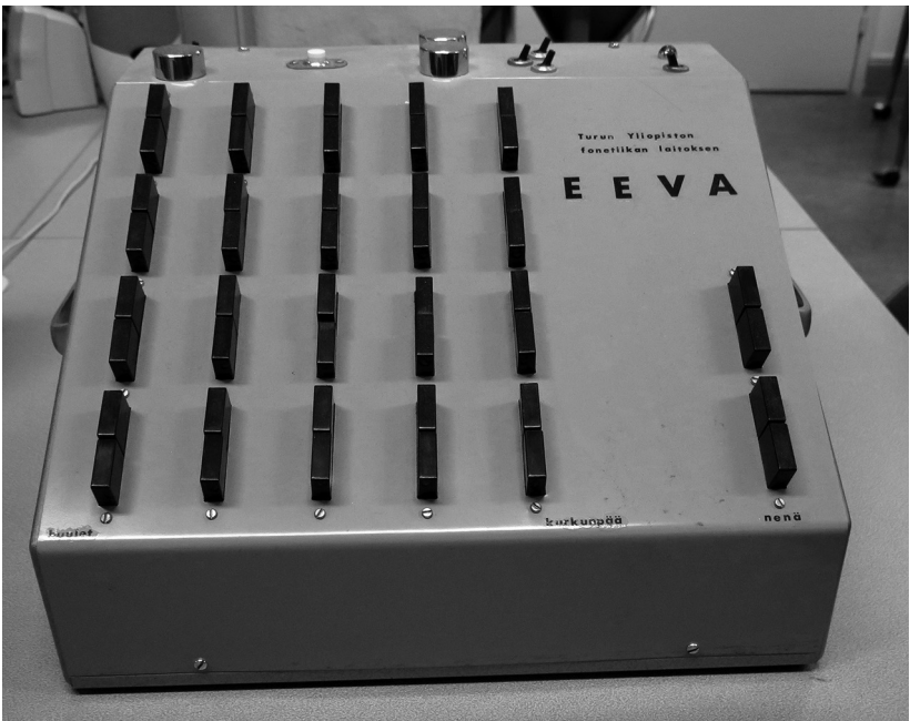
Bild 9.2. Syntetiseraren Eeva, tillverkad i slutet av 1960-talet på fonetiklaboratoriet i Åbo. Foto: Tiina Männistö-Funk.
